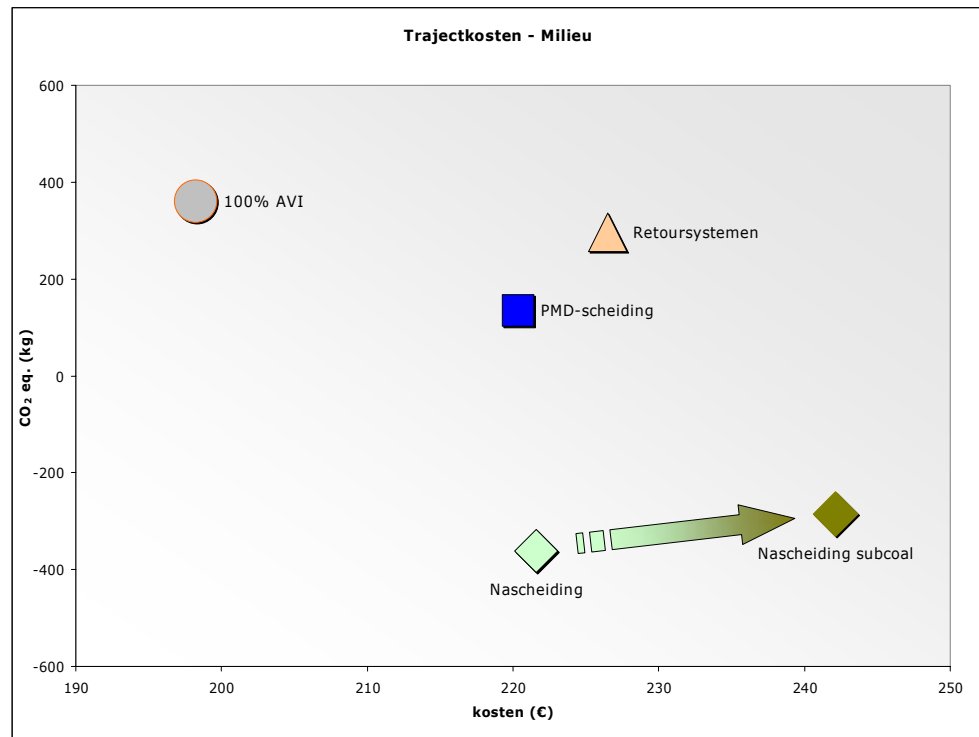
Figuur 19 Gevoeligheid voor vervanging van recycling flessen/flacons en drankenkartons door de productie van subcoal voor de relatie tussen de trajectkosten (€) en het broeikaseffect (kg CO 2 equivalenten) per ton verpakkingen voor het traject 'Nascheiding'.
